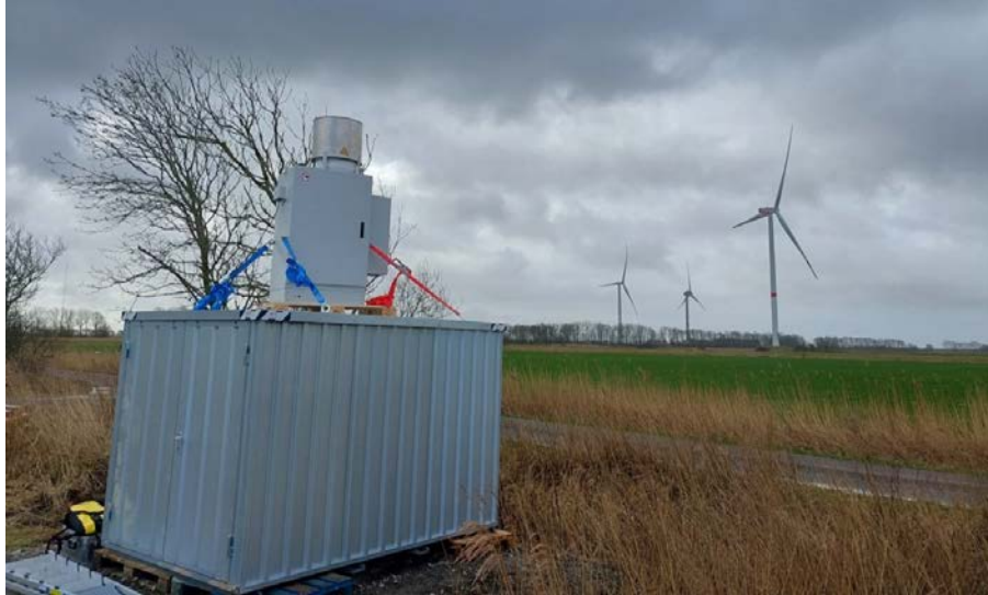
Εικόνα 1: Άποψη του ραντάρ που χρησιμοποιήθηκε στη μελέτη για συνεχή καταγραφή μεταναστευτικών πτήσεων και ύψους πτήσης πουλιών γύρω από το αιολικό πάρκο (έγιναν εκατομμύρια πραγματικές καταγραφές πεδίου επί σχεδόν δύο χρόνια συνεχούς λειτουργίας). Το σύστημα μπορούσε να διακρίνει διαφορετικές ομάδες πτηνών (echo signature characteristics), δίνοντας πολύ αξιόπιστες κατανομές μεταναστευτικών ροών ανά ομάδες πτηνών. “Photo credit: BioConsult SH (2025), The collision risk of migrating birds at wind turbines”
