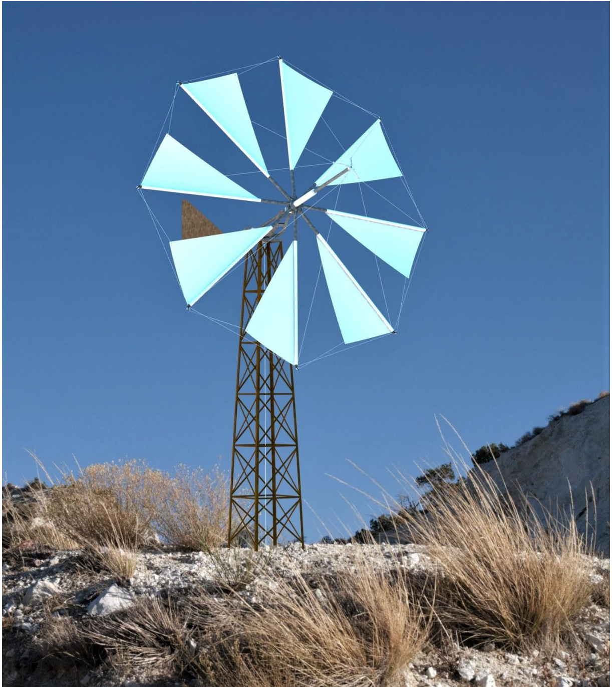
1 η Φωτογραφία Ο Ανεμουργός στην τελική του μορφή. Διακρίνεται το ηλεκτρικό καλώδιο στη θέση της ρόκας της ανεμαντλίας. (Σχεδιάστηκε από τους Κονταξάκη Γιώργο και Χάμψα Γιώργο)
