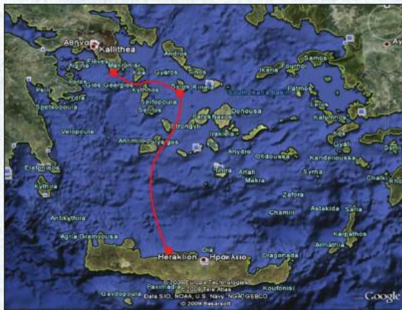
Σχήμα 5α: Διαγραμματική απεικόνιση της ηλεκτρικής διασύνδεσης Κυκλάδων και Κρήτης με κοινό σύνδεσμο HVDC τριών σημείων
